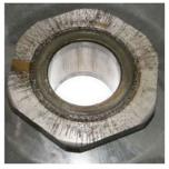
注1:ニードルゲージベアリング又はプレーンベアリングと O-リングを正しく取り付けてください。
