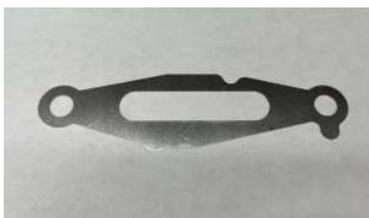
排気バルブ プロテクションプレートが必備となり、シリンダー側に取り付けます。
