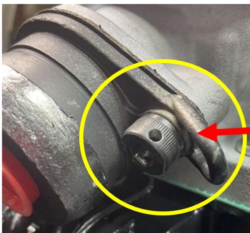
※封印ボルトを取り付けて下さい。
