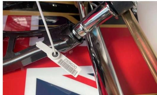
Micro/Mini は右側ナックルの上に取り付けます。
